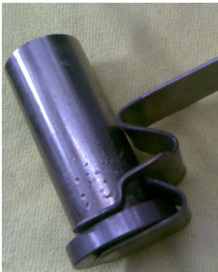
Рис. 2.4 Тигель з тримачем для розплавлення поліпропілену
