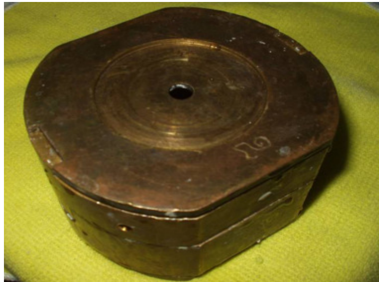
Рис. 2.2 Кювета для виготовлення протеза з поліпропілену
